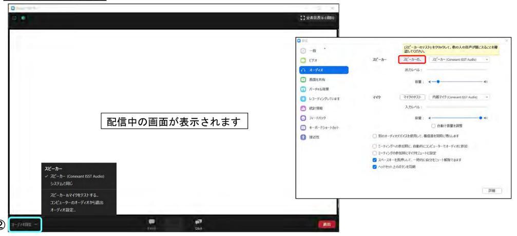
オーディオ設定をクリックすると設定ウインドウがオーディオを選択した状態で表示されます。 使用されるオーディオ機器の変更、音量の調整、スピーカーのテストができます。 赤枠をクリックするとテスト音が流れますのでスピーカーのテスト、音量の調整を行ってください。 尚、音量はPC本体の音量操作と連動しています。
